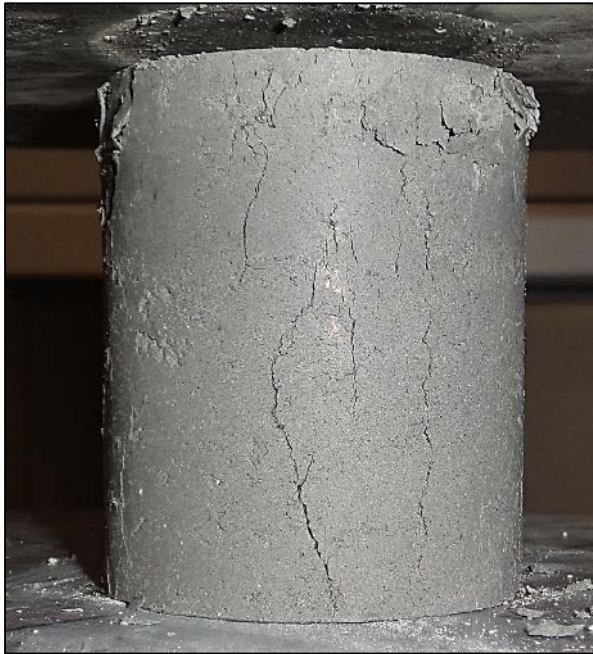
Druckprüfung Proctor-Prüfkörper von Schlacke <0.063 mm
